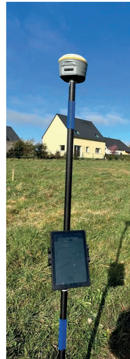
Le kit piéton Idig intègre un logiciel topo exploitable sur n'importe quelle tablette Android du marché, une canne topo avec antenne GPS, la même que pour le guidage. Cette antenne peut fonctionner en mode radio avec une station fixe.
