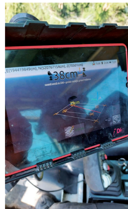
L'écran de guidage 3D Connect est plus large avec une vue complète de l'engin dans son espace.
